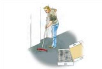
Damit die Verlegefläche eine zusammenhängende Einheit bildet, sind die Systemplatten mit den beigefügten Haltestegen ineinandersteckbar. Die Verlegung erfolgt wie beim Bodenbelag „schwimmend“ und
