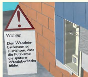
Stellen Sie sicher, dass die Putzkante die tatsächliche, spätere Wandvorderkante bildet. Es dürfen max. 13 mm Abstand zwischen Wandeinbaukasten und späterer Wandoberfläche entstehen. Zum Schluss ist das Lüftungsgerät im Wandeinbaukasten zu montieren.
