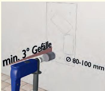
Mit dem Kernbohrgerät zwei Kernbohrungen  $\varnothing$  80-100 mm nach außen für das Fortluft- und Außenluftrohr vornehmen. Damit entstehendes Kondensat nach außen ablaufen kann, ist ein Gefälle von 3° nach außen unbedingt einzuhalten!
